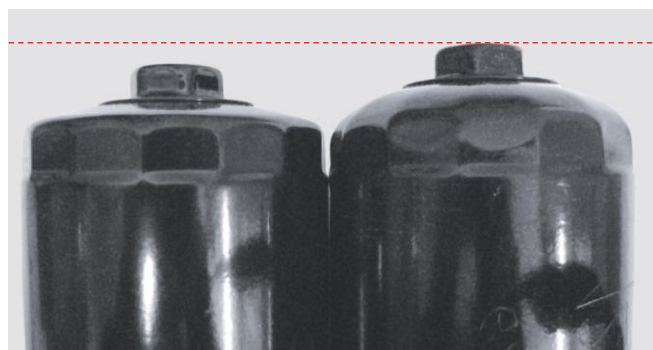
Fig. 3: Filtre de ulei, comparație prin alăturare; stânga - normal, dreapta - deformat
