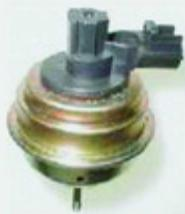
Aripiorele mobile ale geometriei variabile se află în poziție deschisă atât timp cât electrovalva nu comandă tija de comandă a dispozitivului de reglare a presiunii turbocompresorului (fig.1).
